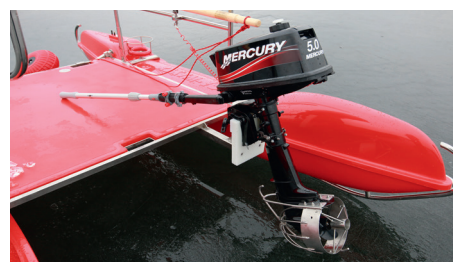
Silnik dwusuwowy 5 KM przystosowany do pracy w wodzie z lodem
