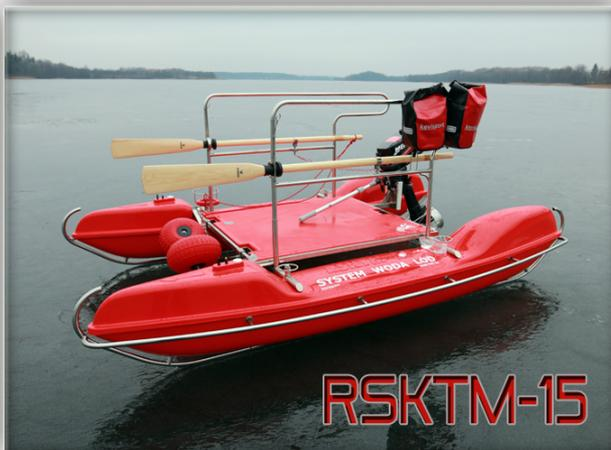
**Система Вода-Лёд — это мобильное круглогодичное спасательное устройство предназначенное для проведения эвакуационных действий в водноледяных условиях, в которых главным препятствием, быстро добраться к пострадавшему, являются ломкий и дрейфующий лёд либо длинный водный путь между берегом и льдом.**
