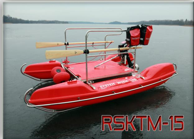
Das Wasser-Eis-System RSKTM-15 ist eine mobile, ganzjährige Rettungsanlage für Evakuierungsmaßnahmen in Wasser-Eis-Bedingungen, in denen das Brechen und Driften der Eisdecke und langer Wasserweg zwischen der Eisdecke und festem Land, der das Erreichen des Opfers behindernde Hauptfaktor ist.
